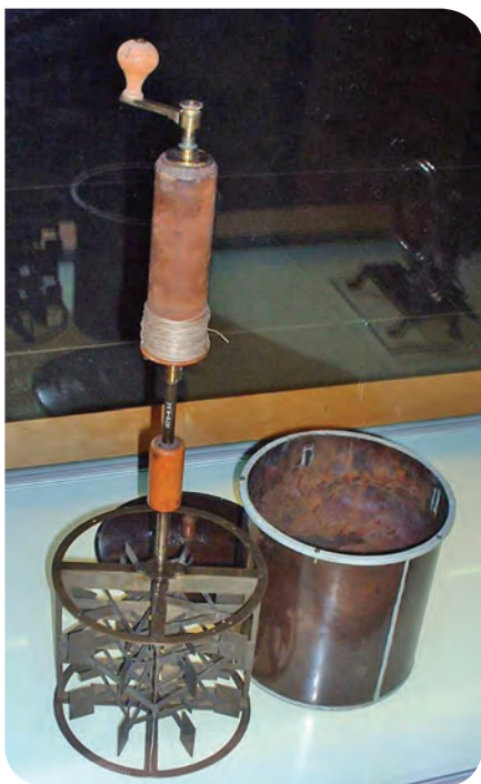
■ Joule készüléke, mellyel meghatározta a hő mechanikai egyenértékét
