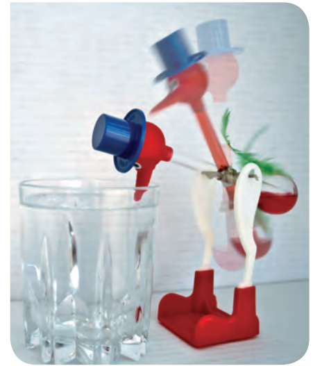
■ A „szomjas kacsa” is egy hőerőgép. Keress az interneten kisfilmet, amelyen működés közben látható! Próbáld megmagyarázni a mozgását!
