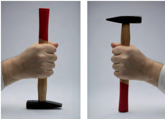
Kétféleképpen próbáltuk a kalapács fejébe a nyelét beleerősíteni
