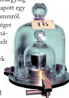
Az öskilogrammról több számozott hiteles másolat készült, a képen a 16. sorszámu, magyar tömegetalon látható
