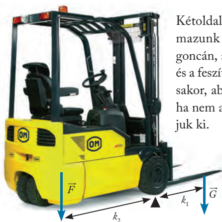
A targonca a kétoldalú emelő elvén működik, a hátsó kerékhez nagy tömegű ellensúlyt építettek be
