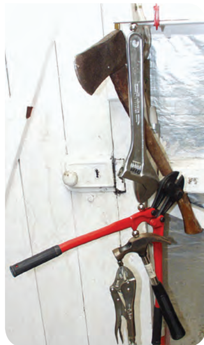
■ Kis méretű neodímium gömbmágnesek nehéz szerszámokat tartanak meg
