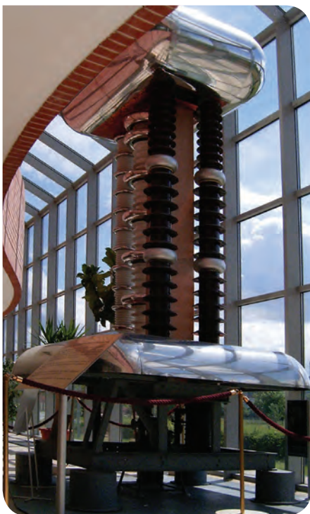
■ A Simonyi-féle részecskegyorsító 1 MV (egymillió volt) feszültséget tudott létrehozni. Ezzel a feszültséggel a fénysebesség közelébe (0,94 c) gyorsították az elektronokat.
