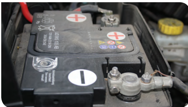
■ Egy személyautó 12 \text{ V} -os, 44 \text{ Ah} -s akkumulátora
