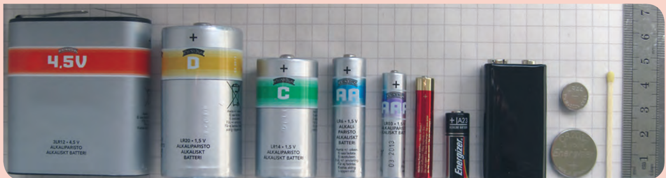
■ A legfontosabb elemméretek összehasonlítása. Balról jobbra haladva: 4,5 V-os, D (Góliát), C (bébi) AA (ceruza), AAA, AAAAA, A23, 9 V-os, CR2032-es gombelem és LR44 gombelem
