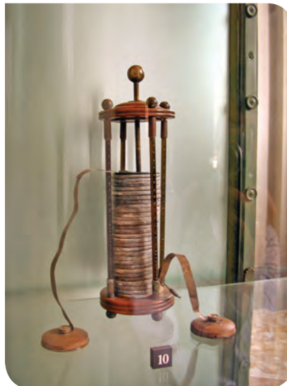
■ Egy Volta-féle oszlop, ami nem más, mint sok Volta-féle elem összekapcsolásával nyert áramforrás
