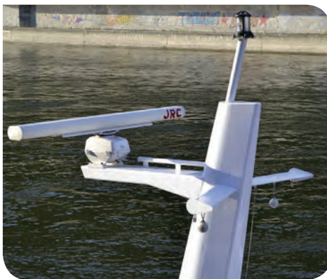
■ Radarral felszerelt hajó antennája és egy radar képernyője
