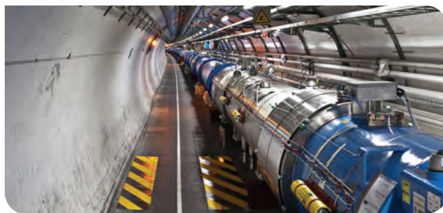
■ A genfi CERN LHC gyűrűje. A kék elemekben található a szupravezető mágnesek
