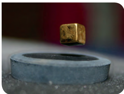
■ Szupravezető mágnes a folyékony nitrogénnel hűtött tégelyben lévő mágnes felett lebeg
