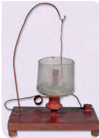
■ Faraday motorja csak a forgó mozgást demonstrálta
