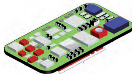
■ Szenzorok egy mobiltelefonban – a pirossal jelölt részek mind szenzorok: mikrofon, kamerák, fényérzékelő, gyorsulásmérő, nyomásmérő stb.
