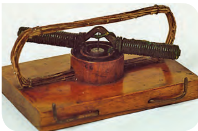
■ Jedlik motorjának – villámdelejes forgonyának – higanyos kommutátora
