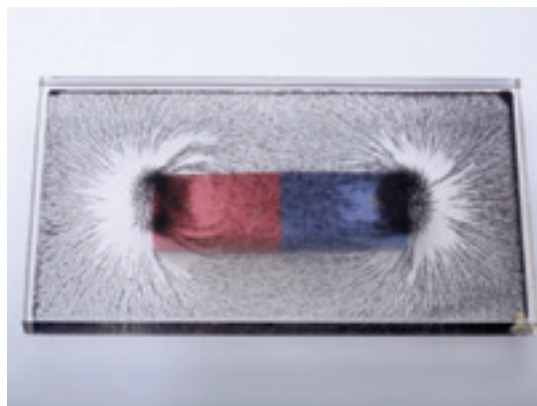
Elektromágnes és mágnesrúd mágneses mezője
