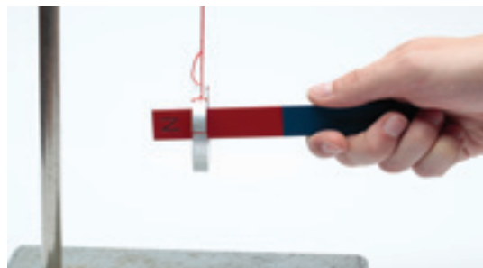
Elektromágneses indukációs kísérlet nyílt karikával
