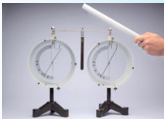
Az elektroszkópok lemezkéinek kitérése a töltött test közelítésekor növekszik
