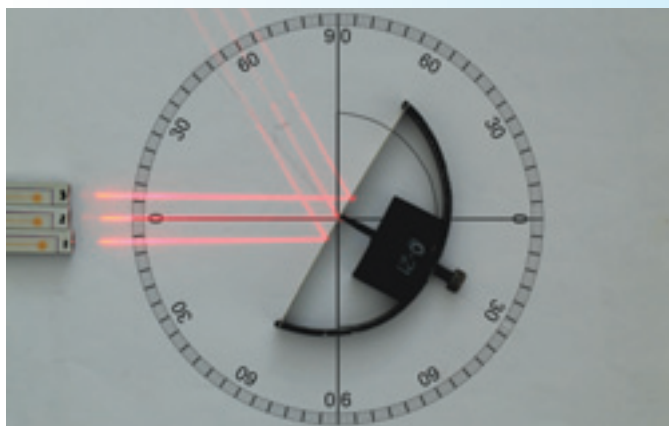
Párhuzamos fénysugarak érkezik a síktükörré, és visszaverődés után is párhuzamosak maradnak
