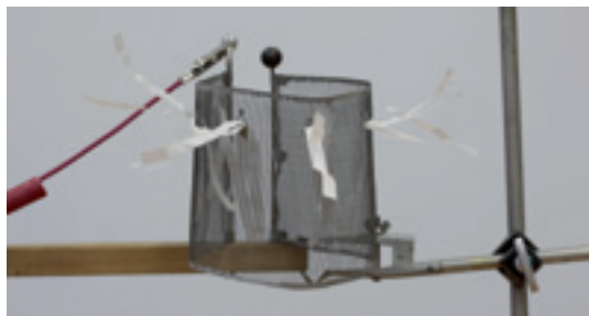
Az egymást taszító azonos töltések a fémháló külső felületén helyezkednek el
