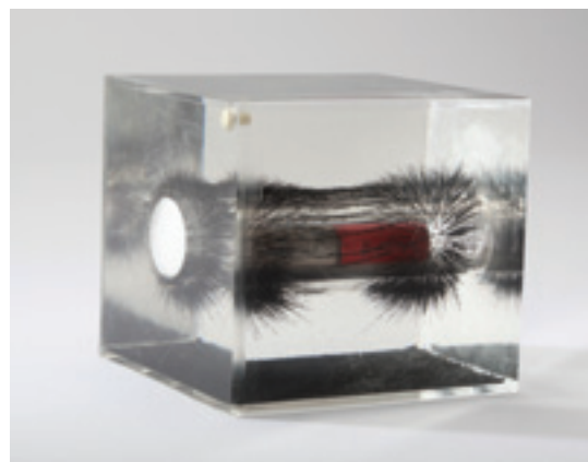
Vasreszelék háromdimenziós elhelyezkedése rúd mágnes környezetében
