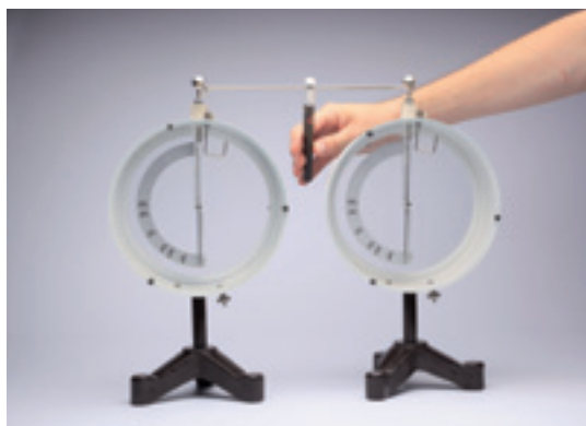
Mindkét elektroszkópon kiegyenlítődnek a töltések
