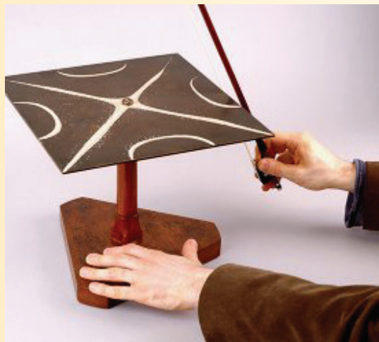
Chladni-féle porábra létrehozása
