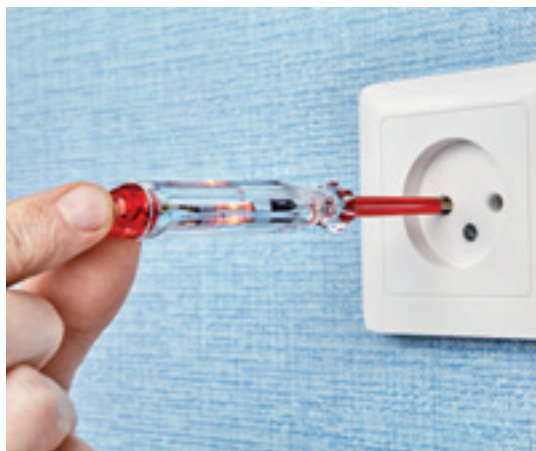
Fázisceruzával megtalálhatjuk a fázisvezetéket
