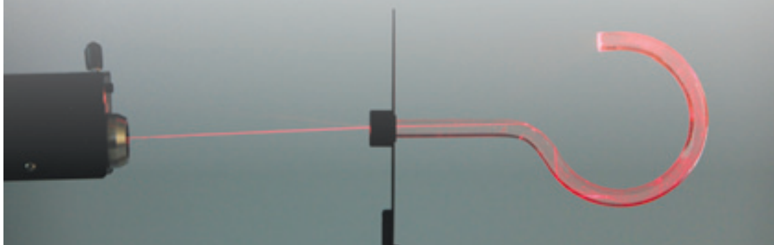
A görbített üvegbotban hasonlóan terjed a fény, mint az optikai szálban
