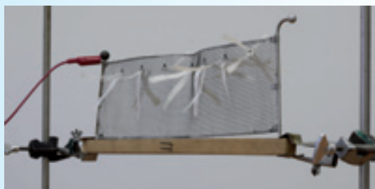
Papírelektroszkópokkal vizsgáljuk a töltések elhelyezkedését a fémhálón
