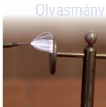
Töltéssel rendelkező fémcsúcs közelében keletkező szikrakisülés
