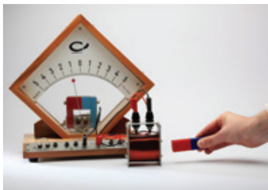
Indukált feszültség létrehozása rúd-mágnessel
