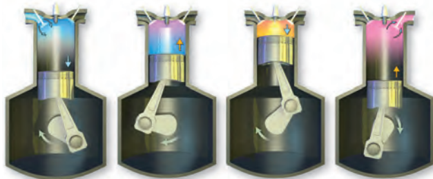
A dugattyú periodikus mozgásának négy üteme
