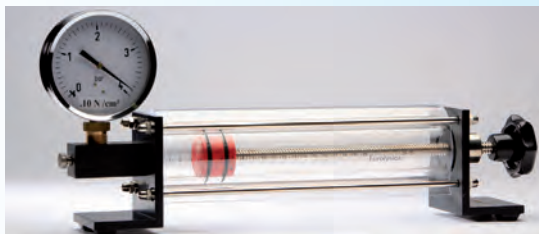
Izoterm állapotváltozás bemutatására készített eszköz
