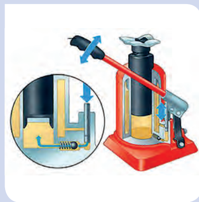
■ Hidraulikus emelő működése
