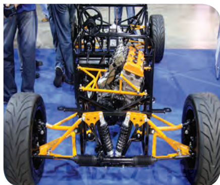
■ Az autók rugózása megoldható csavar- és laprugóval is
