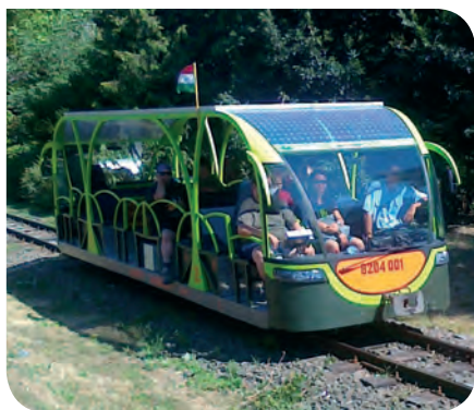
■ Szolgálatba állt a Királyréti Erdei Vasút legújabb járműve, a napelemekkel működő elektromos motorvonat, neve Vili
