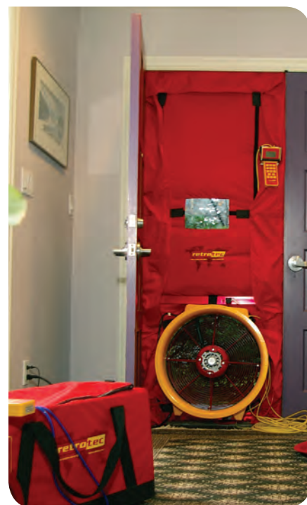
■ A Blower door teszthez használatos felszerelés
