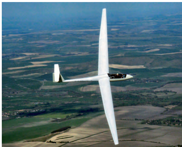
A vitorlázó repülőgép a feláramló meleg levegőt is használja az emelkedéshez
