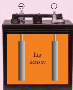
Az ólomakkumulátor egy cellájának felépítése
