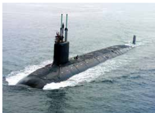
A PCU Virginia amerikai atom-tengeralattjáró. Az atom-tengeralattjáró meghajtásáról egy kisebb atomreaktor gondoskodik, a hajótestben tizenhat-huszonnégy atomtöltetű rakétát helyeznek el. A hidegháború idején egy-egy atom-tengeralattjáró nukleáris tölteteinek ereje több mint ezerszerese volt a Hirosimára ledobott atombombához képest. Az atom-tengeralattjáró a legütőképesebb stratégiai fegyver napjainkban is, mert a világ bármely pontjáról képes a hat-tízezer kilométeres hatótávolságú ballisztikus rakéták megindítására, miközben nehezen lehet felderíteni
